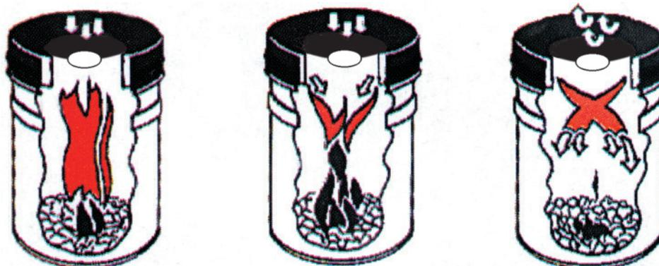
Wenn Feuer entsteht, stauen sich die aufsteigenden Verbrennungsgase unter dem Deckel. Durch die Reduzierung der Sauerstoffzufuhr wird die Ausbreitung des Feuers gehemmt.
